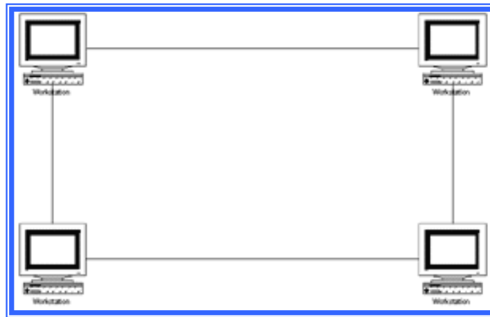
Figura 4 Topología Anillo Fuente: www.cisco.com
