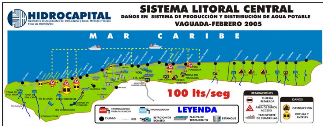
Figura 36. Daños que sufrió el sistema en febrero de 2005 ocasionando una severa disminución de su caudal de distribución.
