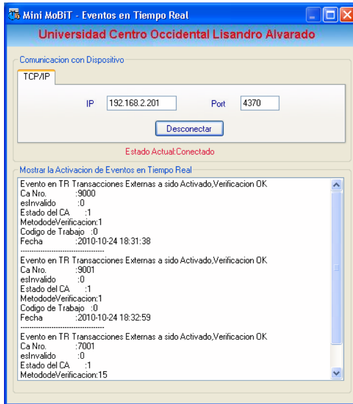
Figura 4.15 Interfase grafica de la aplicación propuesta - Monitor en tiempo real
