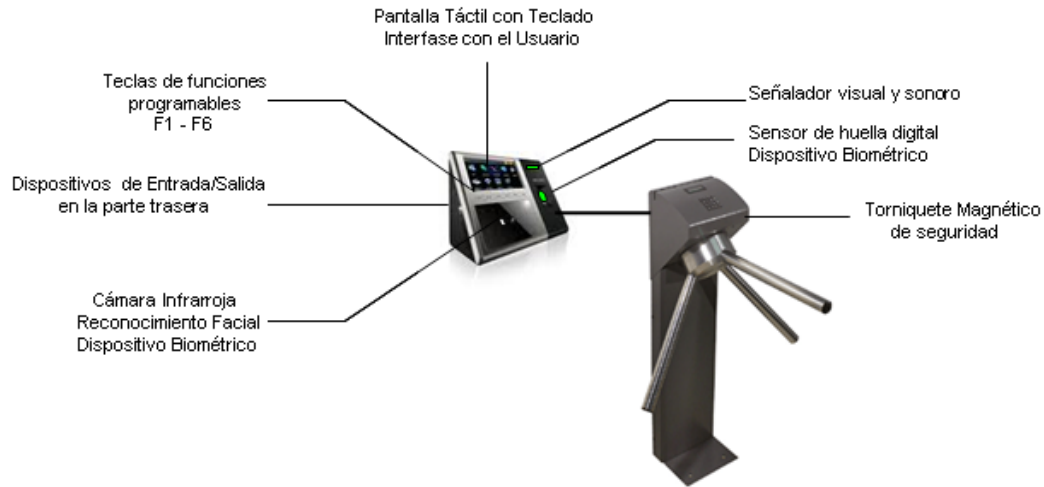
Figura 3.3 Componentes principales del dispositivo de verificación
