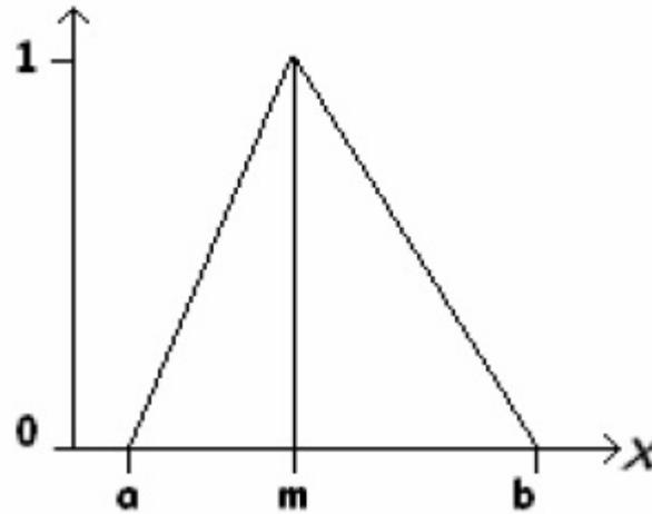
FIGURA 1.2: FUNCIÓN DE PERTENENCIA TRIANGULAR
