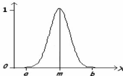
FIGURA 1.3: FUNCIÓN DE PERTENENCIA GAUSSIANA
