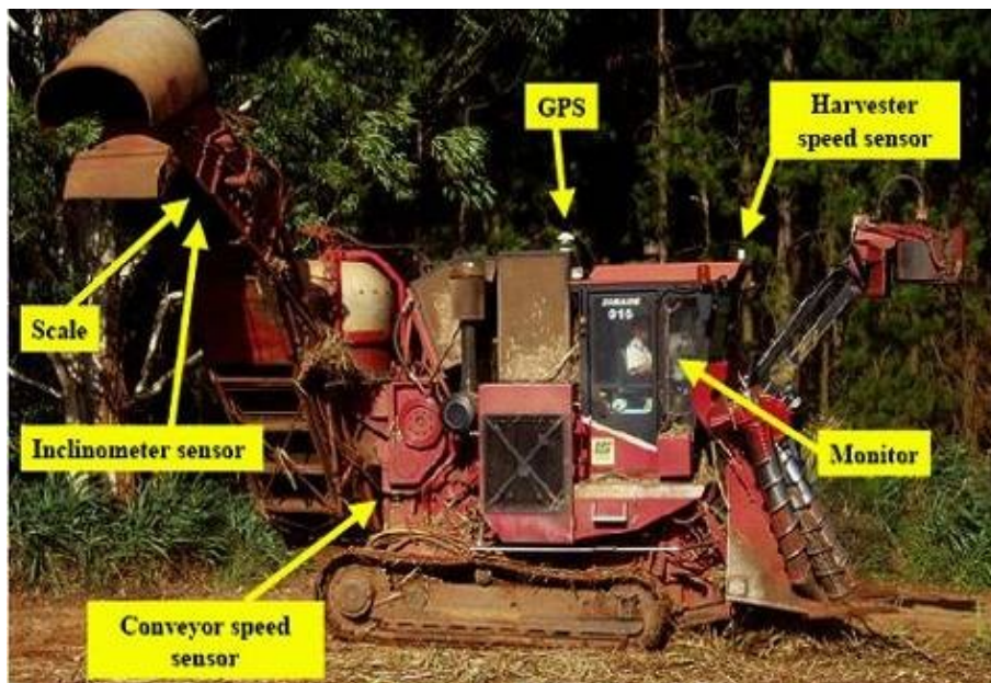
Figura 3: Cosechadora de caña de azúcar con equipo GPS instalado.
