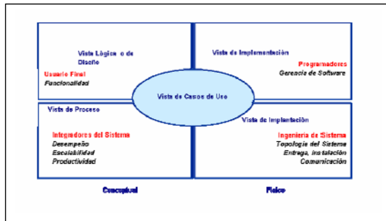
Figura 5: Arquitectura del Software: 4 + 1 vistas.
