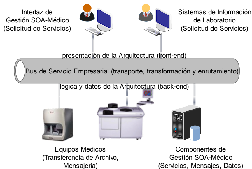
Figura 18. Aproximación Arquitectural. Fuente: Autor de la Investigación.
