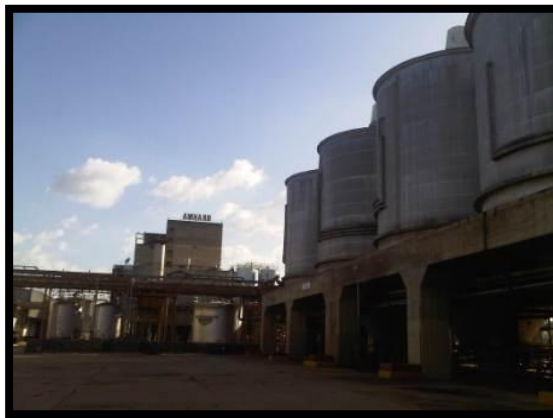
Figura 6. Vista frontal de los tanques fermentadores y maduradores. Fuente: Nuñez y Torrealba (2012)
