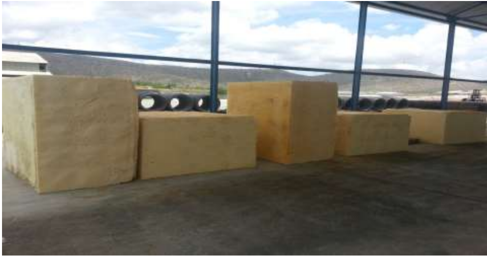
Imagen 7. Almacenamiento de los Bloques para el Proceso de Curado.
