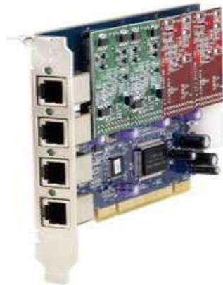
Figura 7. Tarjeta de comunicaciones para conectar hasta cuatro líneas analógicas
