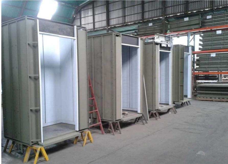
*Figura No. 3: Cabinas de Ascensores terminadas*
