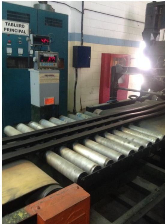
Anexo 2. Proceso de Extrusión (Balanza para controlar peso por metro de perfiles)
