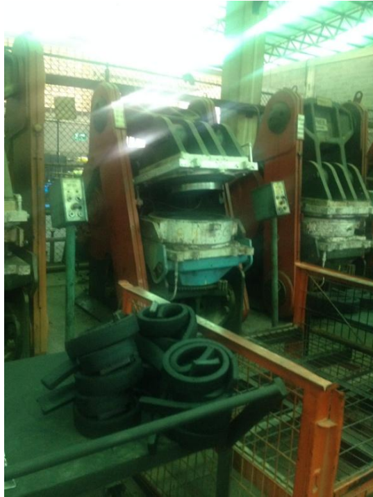
Anexo 4. Material semi-elaborado listo para ser vulcanizado
