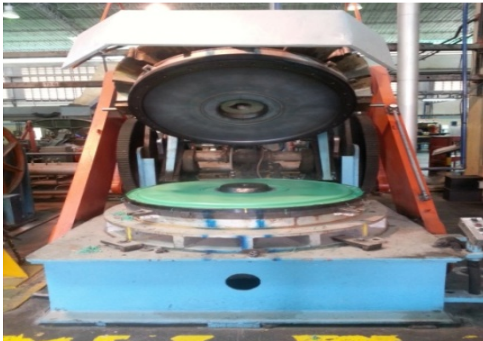
Anexo 2. Máquina para la Vulcanización de Envelopes, Modelo McNeil 75
