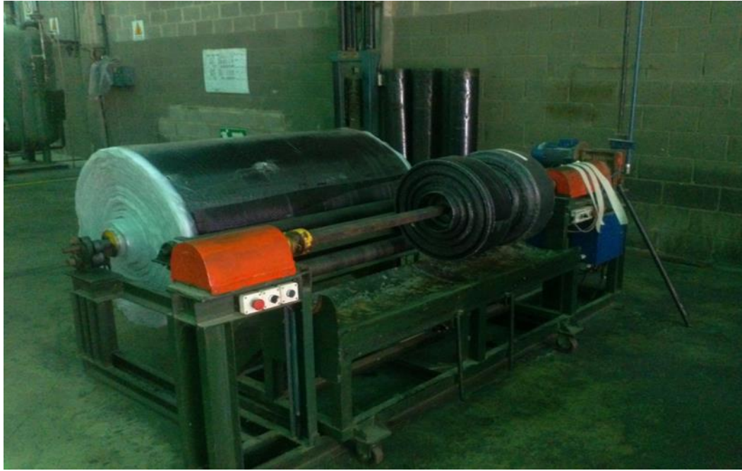
Anexo 7. Cortadora de lona para cauchos industriales para montacargas
