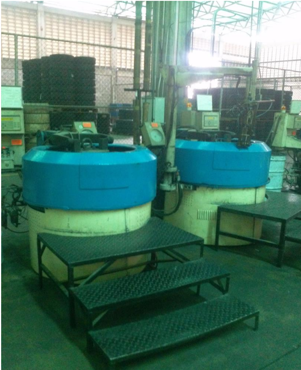
Anexos 6. Prensas ITALMATIC de cauchos industriales para montacargas.
