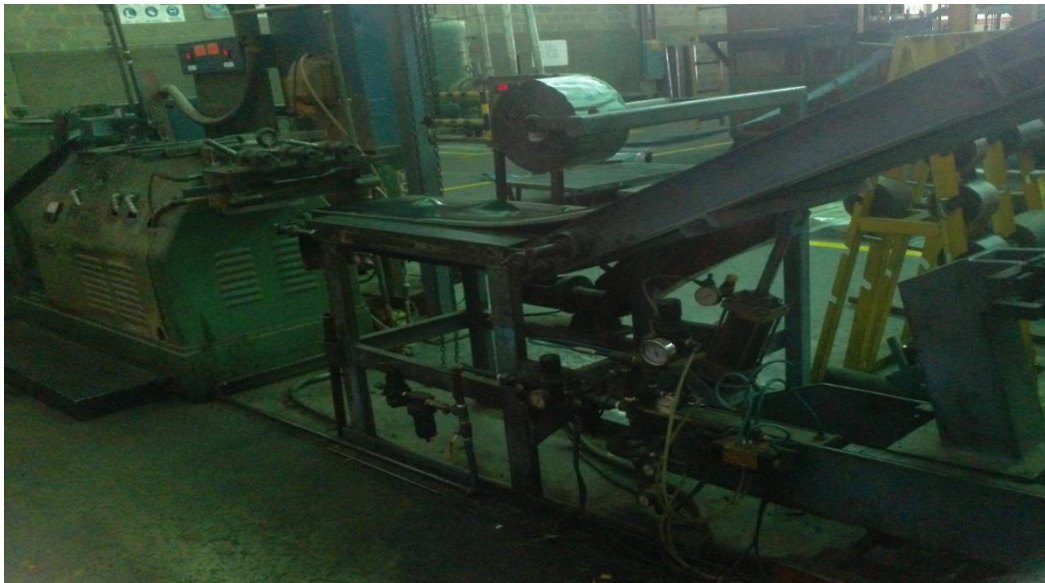
Anexo 8. Extrusora de una línea para armado de talón.
