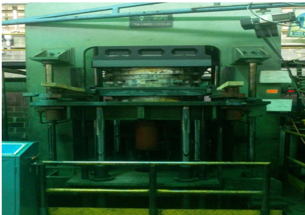
Anexo 5. Prensa Saspol de cauchos industriales para montacargas. Fuente: Suministrada por la empresa
