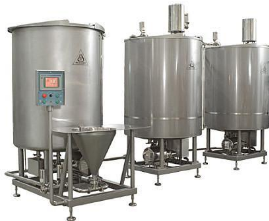
Figura N° 10: Tanques de Almacenamiento de Salmuera
