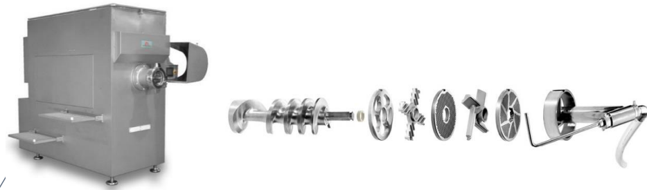
Figura N° 156: Molino para elaborar Mortadela (Izquierda); Discos de Cortes (Derecha)
