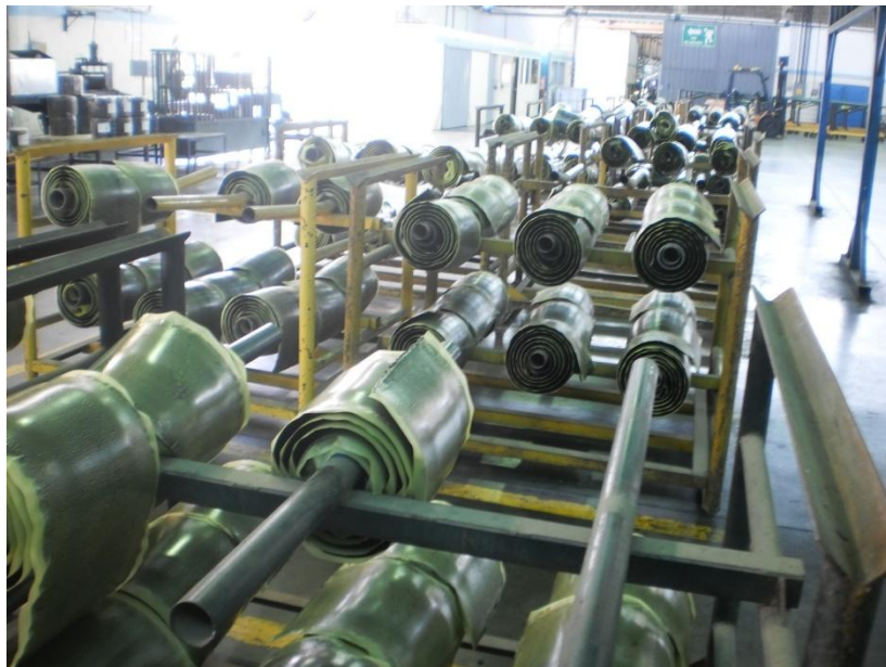
Almacen de camelbacks para cauchos convencionales.
