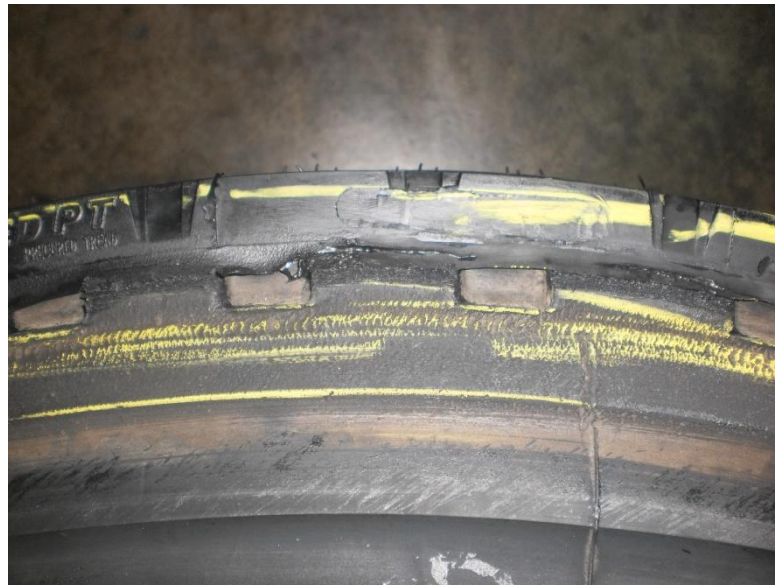
Caucho renovado con falta de cojín.
