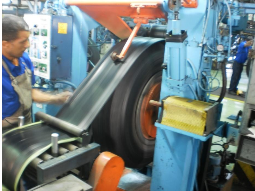
Estación de embande de cauchos convencionales.
