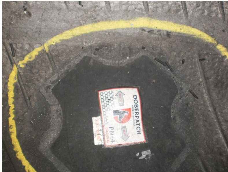
Caucho renovado con parche que presenta aire atrapado.
