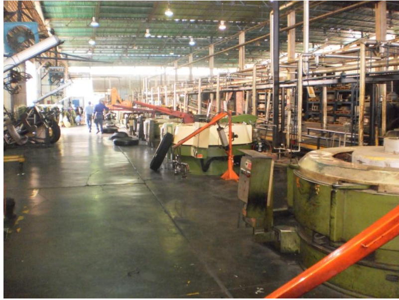
Prensas de vulcanización de cauchos convencionales.
