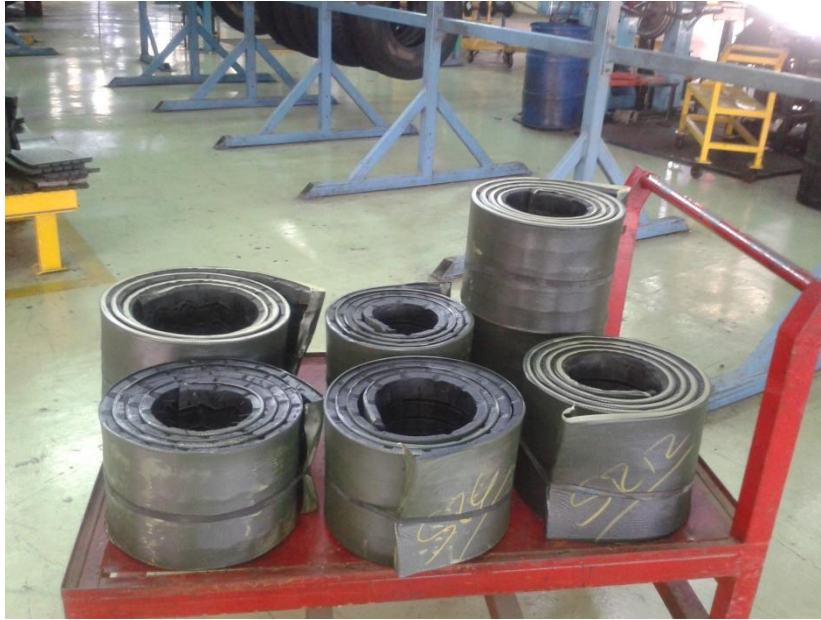
Carro de transporte con bandas pre vulcanizadas para cauchos radiales.
