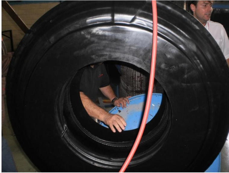
Caucho radial con envelope en espera para entrar al autoclave.
