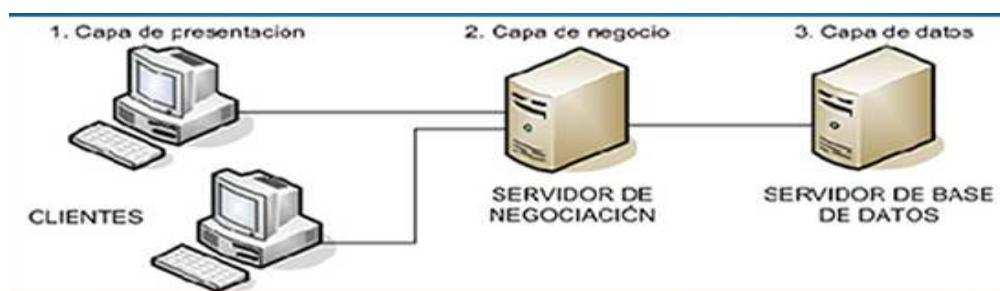
Figura 41: Arquitectura de 3 Capas.
