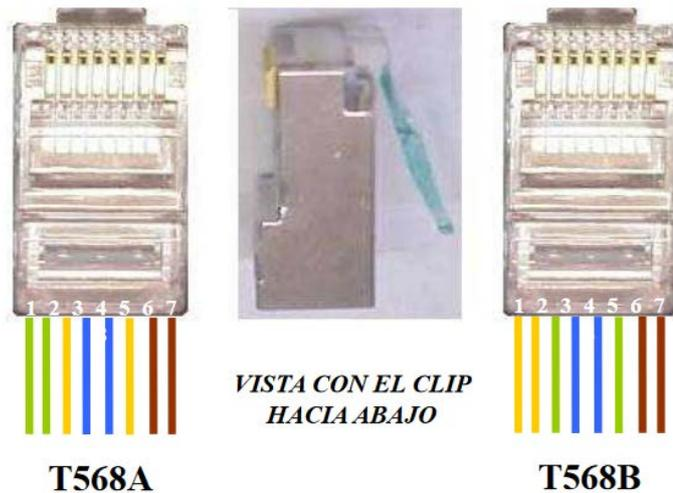
**Figura 16.** Conexión del conector RJ-45.
