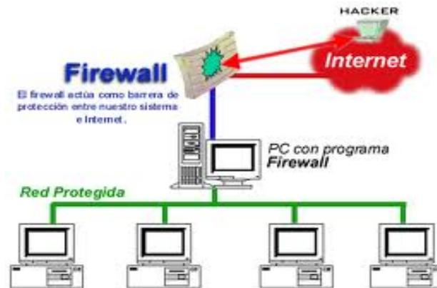
**Figura 21.** Detalles del funcionamiento de un Firewall
