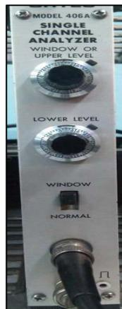
Figura 3.7 Analizador monocanal
