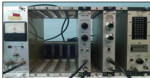
Figura 3.4 NIM ORTEC modelo 484.
